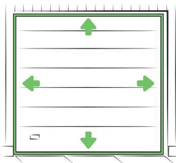
Секционные ворота «АЛЮТЕХ» по всему периметру оснащены эластичным резиновым уплотнителем на основе полимерного каучука. Боковой и верхний уплотнители имеют два лепестка. Это способствует лучшей тепло- и звукоизоляции ворот.
